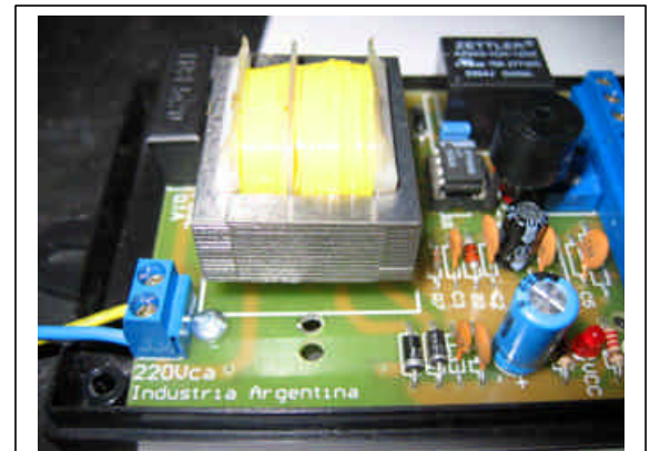
Fig. 3: Conexión de la alimentación
